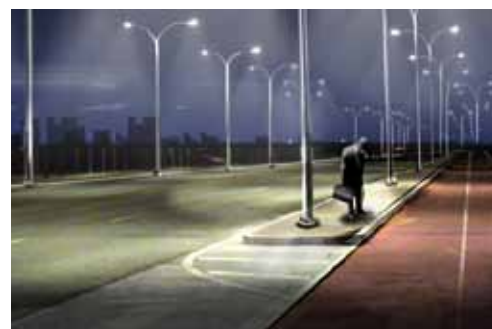
Το Citysense, όπως αποκαλείται το σύστημα ανιχνευτών, έχει τη δυνατότητα να χαμηλώνει τον φωτισμό όταν δεν χρειάζεται και να δίνει όλη την ένταση, μόλις ένα άτομο εμφανιστεί, έτσι ώστε να βρίσκεται πάντα σε ένα ασφαλές κύκλο φωτός.
