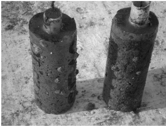
Σχήμα 3. Δοκίμια οπλισμένου κονιάματος μετά από περίπου 3.5 μήνες εμβάπτισης
