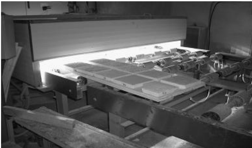
Εικόνα 4. Έξοδος δειγμάτων από το ξηραντήριο υπεριώδους ακτινοβολίας.
