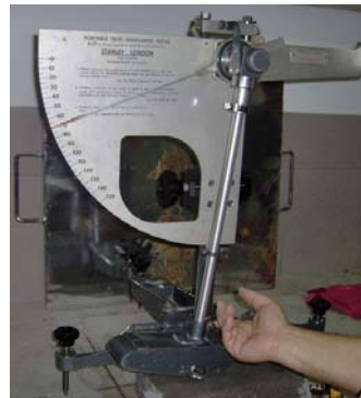
Διάγραμμα 1. Αποτελέσματα και διάταξη μέτρησης της αντίστασης σε ολίσθηση σκυροδέματος με φθαρμένα ελαστικά.
