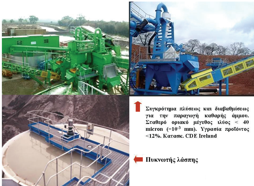
Εικόνα 6. Μηχανικές μονάδες του συγκροτήματος πλύσεως και διαβαθμίσεως αδρανών υλικών από ανακύκλωση παλαιών σκυροδεμάτων (πηγή CDE Ireland).
