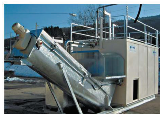
Μεταφερόμενο συγκρότημα ανακύκλωσης επί μεταλλικού ελκθηρού (κατασκ. Bibko)
