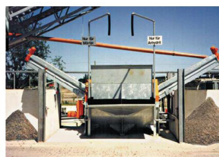
Συγκρότημα ανακύκλωσης με δύο αποστραγγιστικούς κοχλίες παραγωγής δύο προϊόντων για κονιάματα και άνοδρο ασβέστιο (κατασκ. Bibko)
