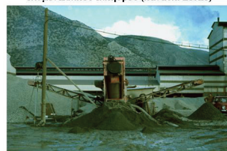
Εικόνα 9. Ανακύκλωση υπολειμμάτων σκυροδέματος σε εργοστάσιο παραγωγής προκατασκευασμένων στοιχείων.
