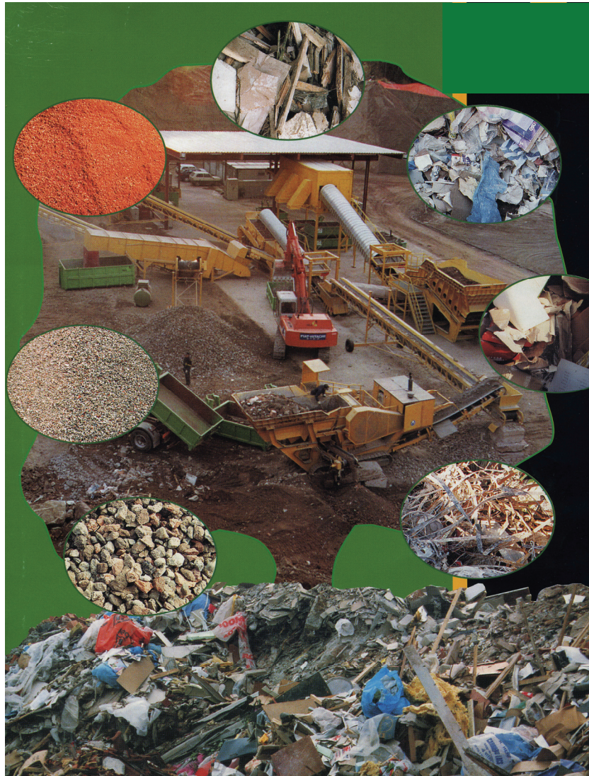
Εικόνα 5. Συγκρότημα ανακύκλωσης παλαιού σκυροδέματος. Πηγή Hartl
