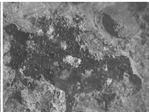
Εικόνα 5. Συγκεντρώσεις αλάτων σε κενά των αδρανών σκωρίας
