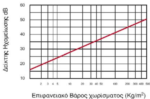
Σχήμα 11. Προσεγγιστικός μέσος δείκτης ηχομείωσης μονών (συμπαγών) χωρισμάτων με βάση το νόμο της μάζας.
