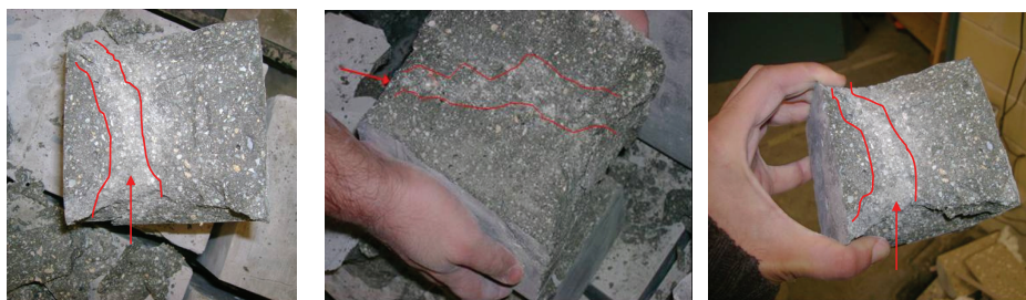
“Εικόνα 3. Φωτογραφία σε δοκίμια των μιγμάτων μετά από τη θραύση σε θλίψη.”
