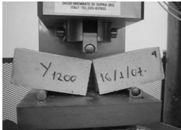
Σχήμα 1: Πρότυπη συσκευή καμπτικής καταπόνησης κονιαμάτων
