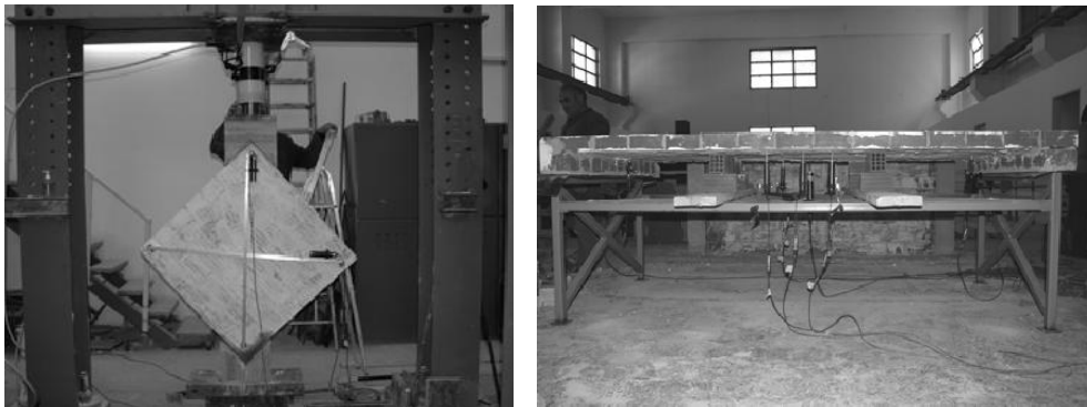
Εικόνα 5: Πειραματική διάταξη δοκιμίων σε διαγώνια θλίψη και σε εκτός επιπέδου κάμψη
