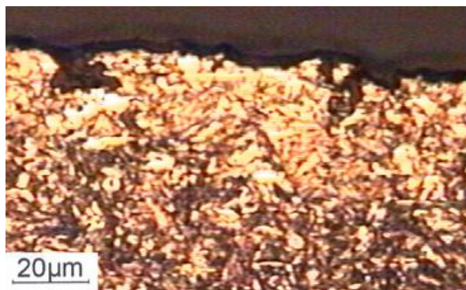
Σχήμα 9. Μικροδομή του χάλυβα S500s Tempcore του δοκιμίου SGO (M X200)
