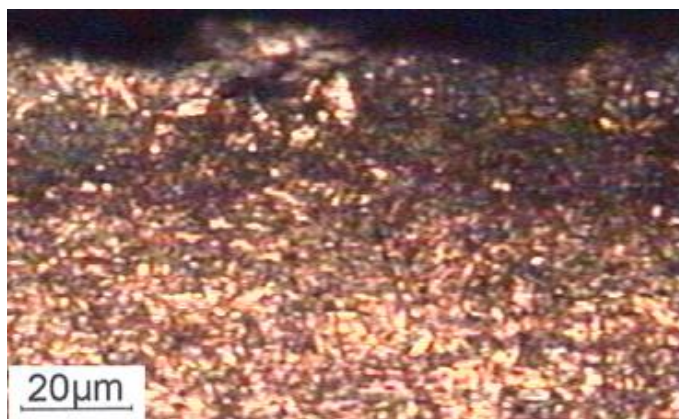
Σχήμα 10. Μικροδομή του χάλυβα S500s Tempcore του δοκιμίου SG60-10 (M X200)
