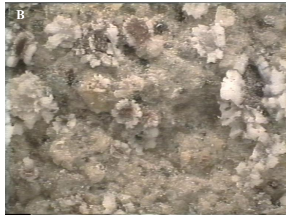
Εικόνα 2. A: Το Καμπαναριό στον ναό του Αγ. Ιωάννη, Σύμη. B: Μικροσκοπία Οπτικών Ινών – Μεγέθυνση x25, Δημιουργία εξανθήσεων αλάτων σε επιφάνεια σκυροδέματος σε θαλάσσιο περιβάλλον
