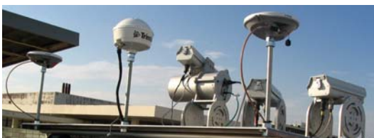
Εικόνα 2. Διάταξη κεραιών συστήματος GPS Figure 2. GPS antennas setup
