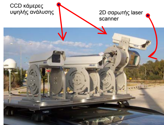
Εικόνα 4. Διάταξη συστήματος οπτικού εντοπισμού και σαρωτή Laser Figure 4. Setup of CCD cameras and 2D laser scanner
