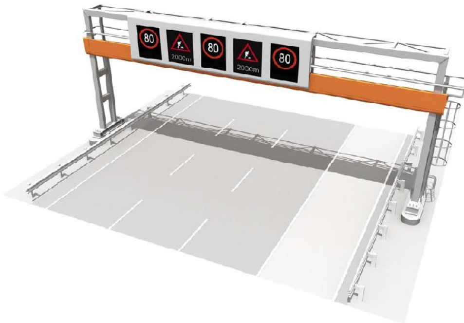
Σχήμα 7. Παράδειγμα τοποθέτησης Πινακίδων μεταβλητής ένδειξης σε γέφυρα σήμανσης πάνω από τρεις λωρίδες κυκλοφορίας
