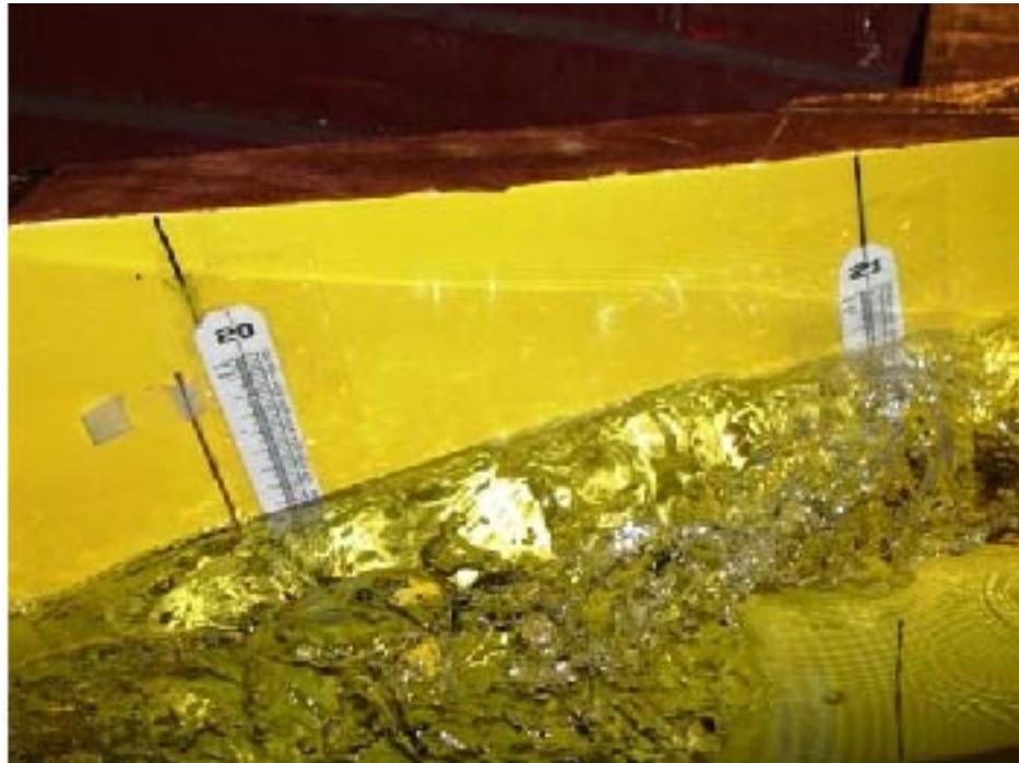
Εικόνα 9: Στιγμιότυπο από τη φωτογράφιση του κύματος επάνω στη γάστρα.
