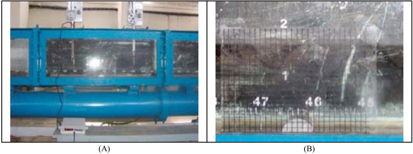
Σχήμα 2: (Α) Η πειραματική διάταξη και ο πειραματικός εξοπλισμός, (Β) Ροή με ελεύθερη επιφάνεια παρουσία του εμποδίου ( Fr=0.22 ). Figure 2: (A) The experimental setup and the experimental equipment, (B) Free surface flow in the vicinity of the obstacle ( Fr=0.22 ).
