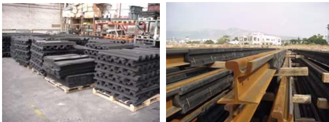
Σχήμα 5: Εφαρμογή ελαστομερούς ενθυλάκωσης στο εργοστάσιο παραγωγής στο Βέλγιο και το εργοτάξιο του Ελληνικού.
