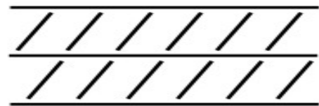
Σχήμα 2-1 Διάταξη νευρώσεων χάλυβα κατηγορίας B500A
