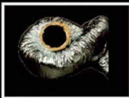
Δύο εύκαμπτοι αεραγωγοί από αλουμίνιο και πολυεστέρα με σκελετό από ατσάλουρμα, τοποθετημένοι ο ένας μέσα στον άλλο.
