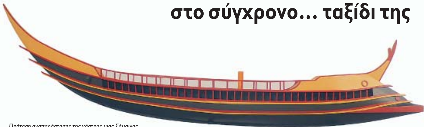
Πρόταση αναπαράστασης της γάστρας μιας Σάμαινας σύμφωνα με τις περιγραφές από τα αρχαία κείμενα και τις παραστάσεις συγγενικών σκαφών. Φυσικό ομοίωμα σε κλίμακα 1:10.
