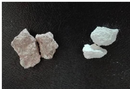
Εικόνα 5 - Δείγματα ασβεστοκονιαμάτων, δύο διακριτών αποχρώσεων
