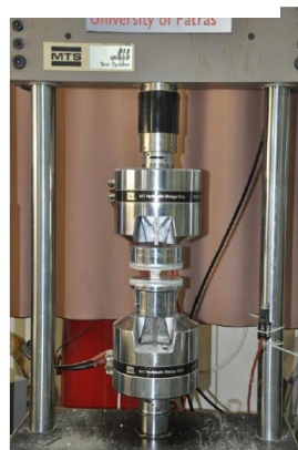
Εικόνα 6 - Εργαστηριακή δοκιμή θλίψης
