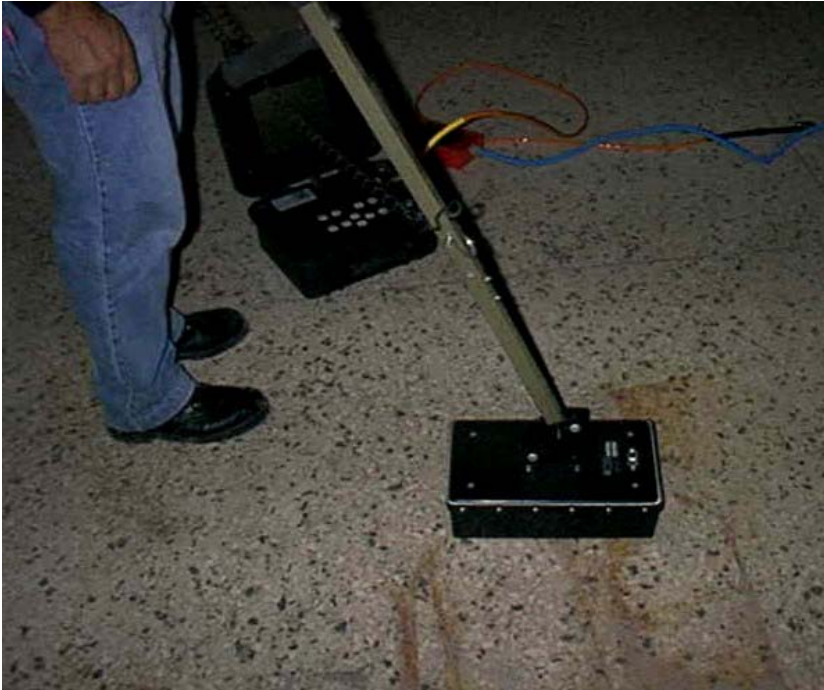
Σχ. 4.12.1 Αντένα Radar ( διακρίνεται και η κεντρική μονάδα)
