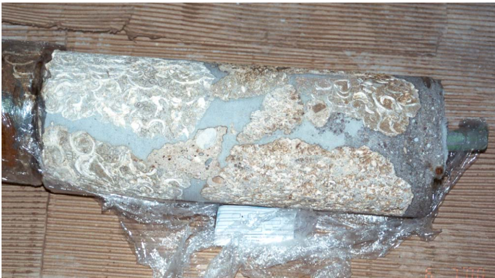
Σχ. 4.2.4.9.2 Δοκίμιο από τοιχοποιία στην οποία είχαν γίνει ενέματα ομογενοποίησης μάζας
