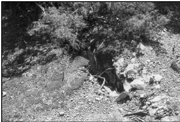
Εικόνες 4 & 5 : Ρωγμές επί του φυσικού εδάφους στο υψηλότερο τμήμα του αντερείσματος
