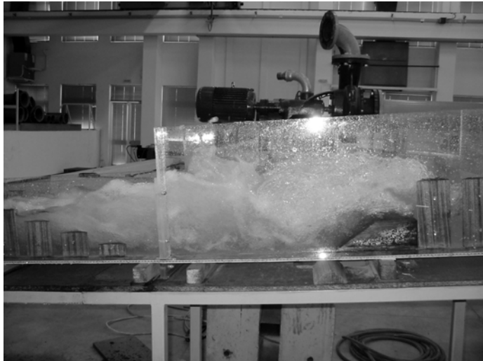
Εικόνα 3. Άποψη τμήματος του αγωγού στην περιοχή της λεκάνης καταστροφής ενέργειας, για τη Δοκιμή 1 (ροή από τα δεξιά προς τα αριστερά).
