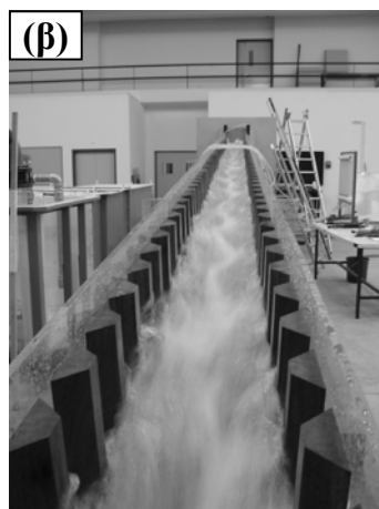
Εικόνα 4. (α) Η ροή στον αγωγό χωρίς λεκάνη καταστροφής ενέργειας, (β) άποψη από τα κατάντη της διαμόρφωσης της ελεύθερης επιφάνειας στον αγωγό χωρίς λεκάνη καταστροφής ενέργειας.
