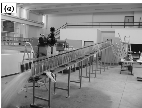
Εικόνα 4. (α) Η ροή στον αγωγό χωρίς λεκάνη καταστροφής ενέργειας, (β) άποψη από τα κατάντη της διαμόρφωσης της ελεύθερης επιφάνειας στον αγωγό χωρίς λεκάνη καταστροφής ενέργειας.
