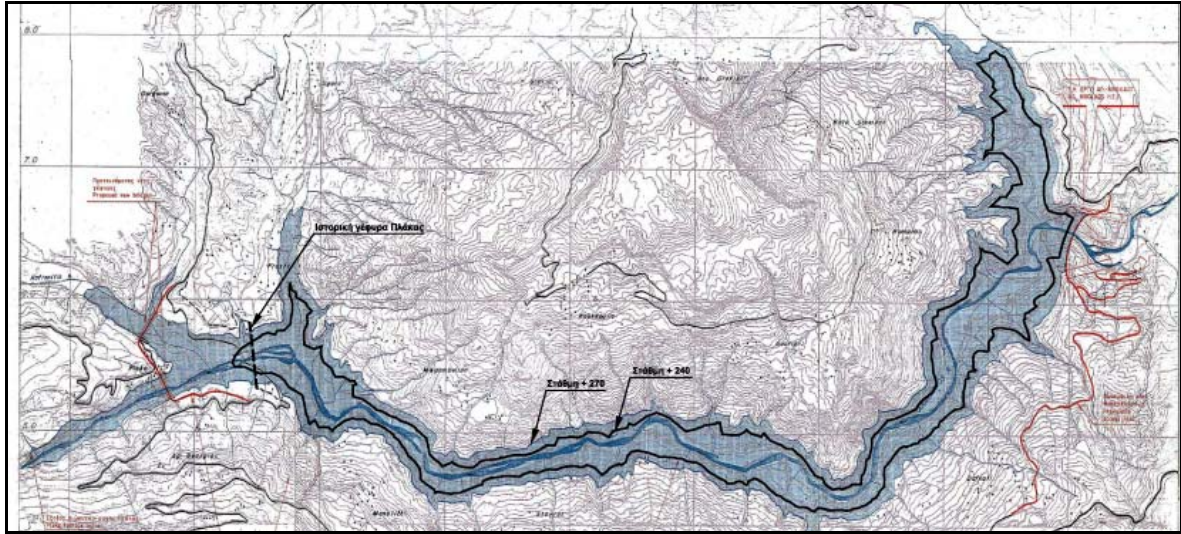
Εικόνα 2: ΥΗΕ Αγίου Νικολάου. Έκταση ταμειντήρα για στάθμες νερού στα υψόμετρα +240 και +270 και σε σχέση με τη γέφυρα Πλάκας
