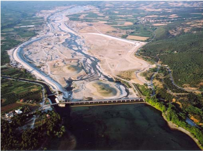
Εικόνα 9: Παλαιά (γεμάτη νερό) και Νέα (διαφαίνεται η ανύψωση φράγματος) Λίμνη Αναρρύθμισης
