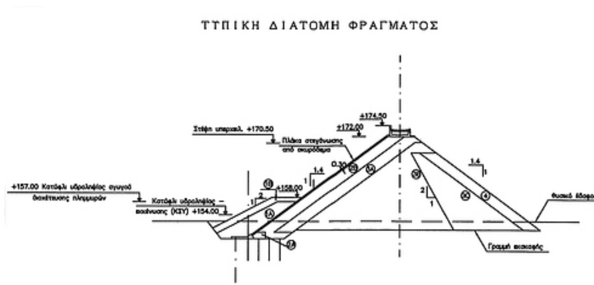
Εικόνα 4: Φράγμα Ραμπεντώσας. Τυπική διατομή
