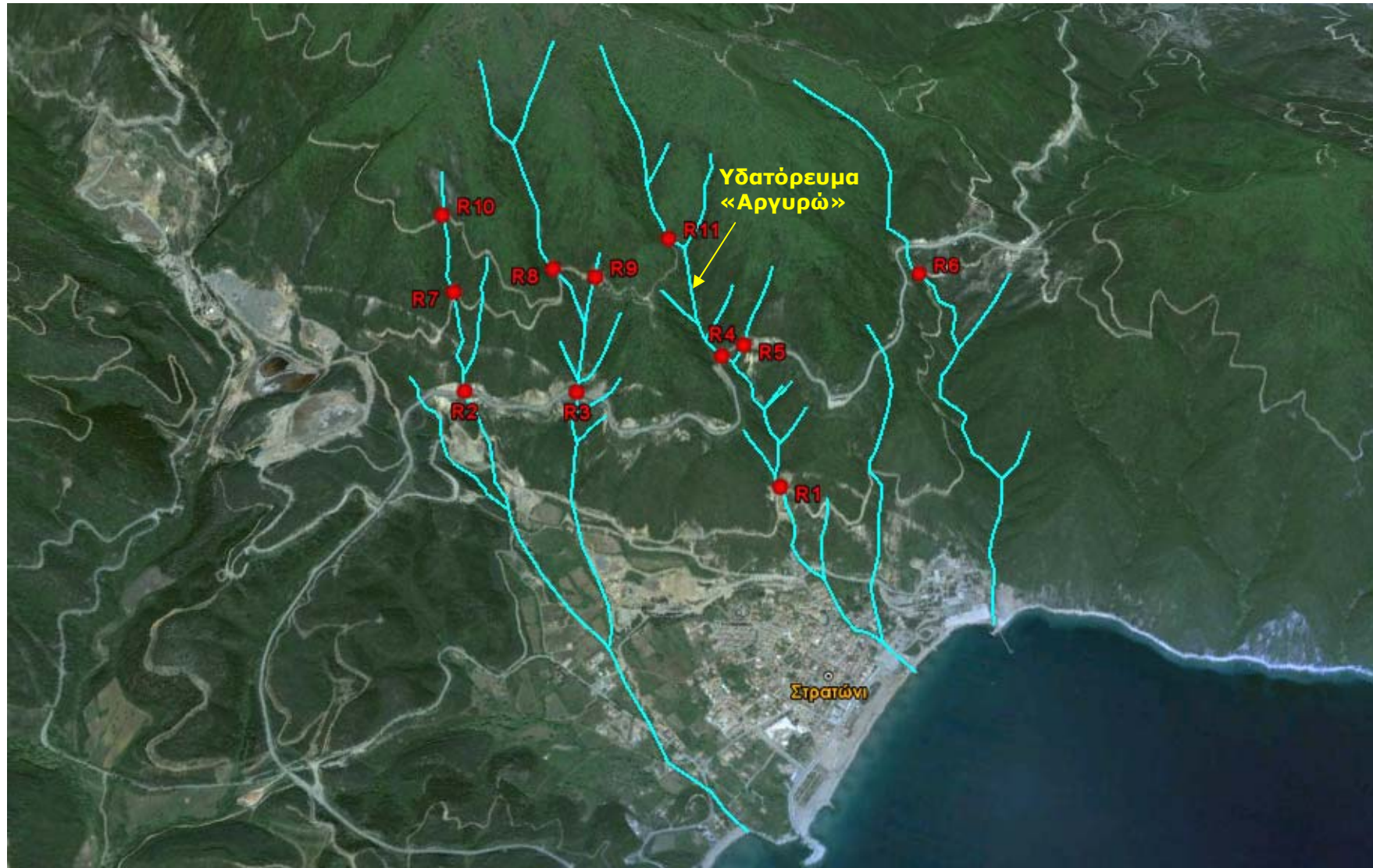
ΕΙΚΟΝΑ 2. Θέσεις που παρουσιάστηκαν προβλήματα στις διασταυρώσεις του κύριου υδρογραφικού δικτύου με το οδικό δίκτυο
