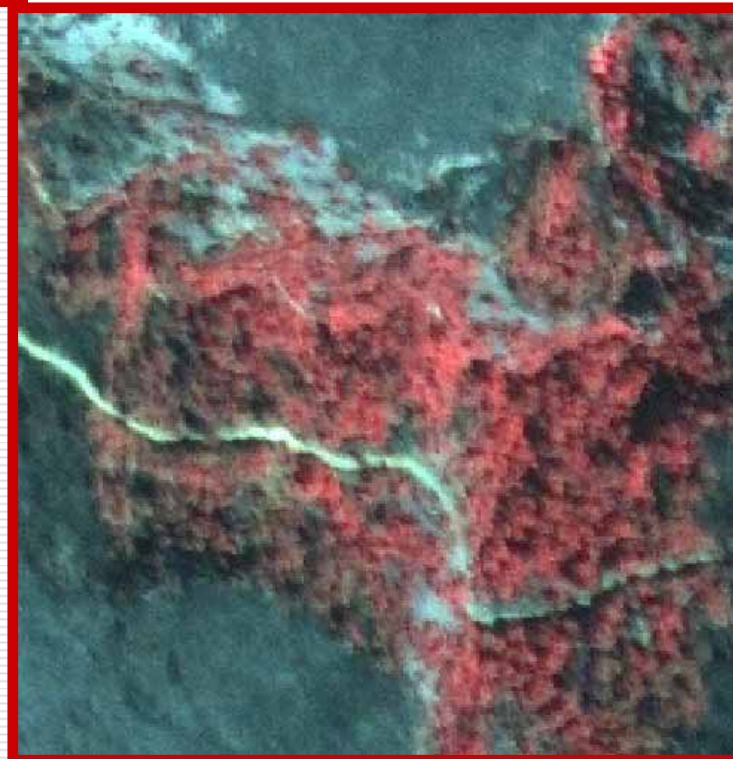
Τμήμα πολυφασματικής δορυφορική εικόνας IKONOS, (R:4, G:3, B:2), της νήσου Σάμου με χωρική διακριτική ικανότητα είναι 1,2 μέτρα. Η εικόνα έχει προέλθει από τη συγχώνευση πολυφασματικών δεδομένων 4μ. και πανχρωματικών 1μ.
