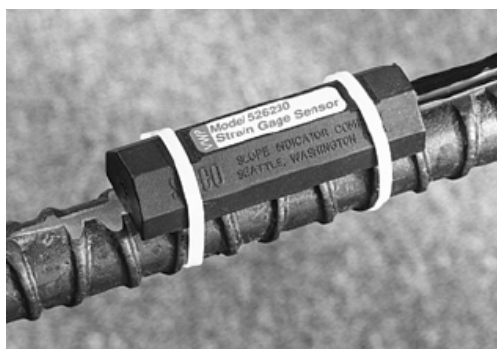
Σχήμα 7.26 Σημειακής συγκόλλησης παραμορφωσιόμετρο τοποθετημένο σε ράβδο οπλισμού. Η συσκευή μέτρησης είναι αδιαβροχοποιημένη με χρήση μαστίχης και ταινίας.
