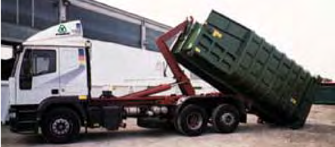
Εικόνα Γ52. Φόρτωση απορριματοκιβωτίου με σύστημα γάντζου 24 .
