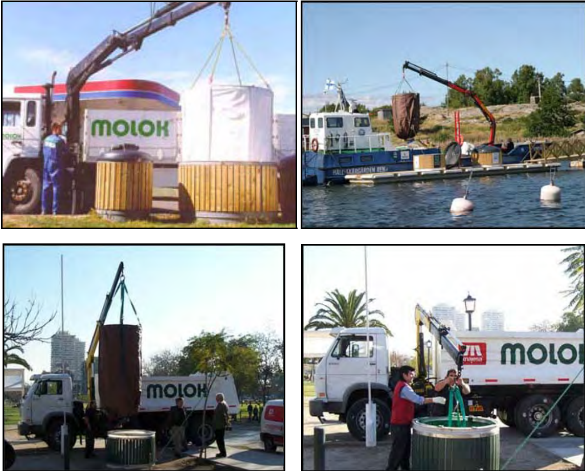
Εικόνα Γ18. Παραδείγματα εκκένωσης ημιπύργειων κάδων με απομάκρυνση του σάκου 11 .
