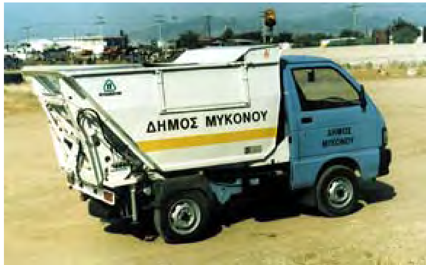
Εικόνα Γ48. Δορυφορικό απορριματοφόρο όχημα με μηχανισμό ανύψωσης 22 .
