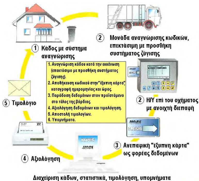
Εικόνα Γ14. Σχηματική απεικόνιση λειτουργίας αυτόματου συστήματος αναγνώρισης κάδων 8 .
