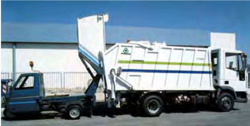
Εικόνα Γ50. Εκκένωση δορυφορικού απορριμματοφόρου οχήματος σε μεγαλύτερης χωρητικότητας απορριμματοφόρο όχημα 23 .
