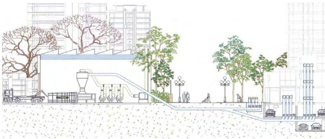
Εικόνα 1.34 Σύστημα συλλογής με πεπιεσμένο αέρα στη Βαρκελώνη
