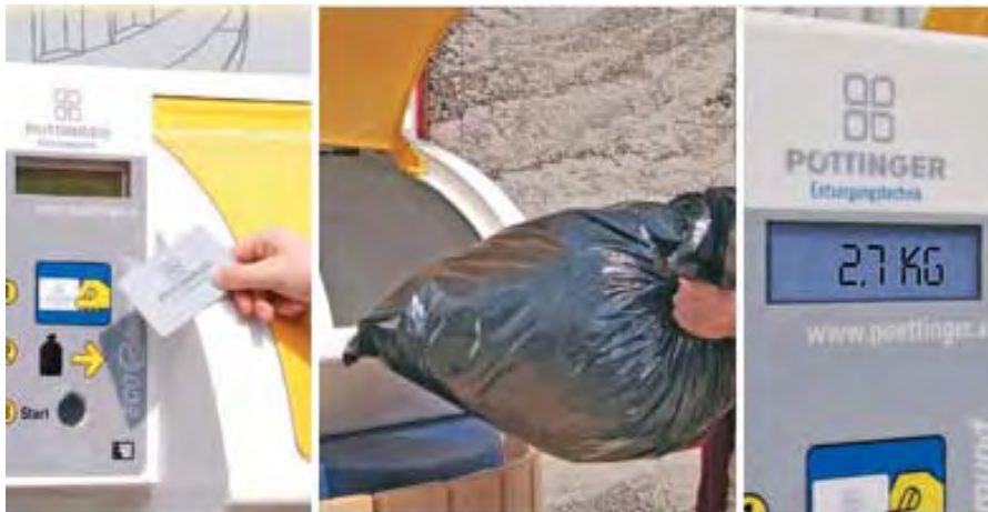
Εικόνα Γ23. Σύστημα αναγνώρισης και ζύγισης απορριμμάτων στο κάλυμμα ημιπόγειου κάδου 13 .
