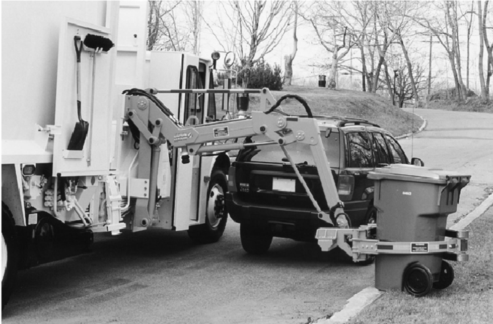
Εικόνα Γ40. Φόρτωση κάδου με απορριματοφόρο όχημα ημιαυτόματης συλλογής (πλάγιας φόρτωσης).
