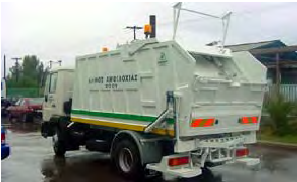
Εικόνα Γ45. Απορριματοφόρο όχημα μεσαίου κυβισμού τύπου πρέσας 19
