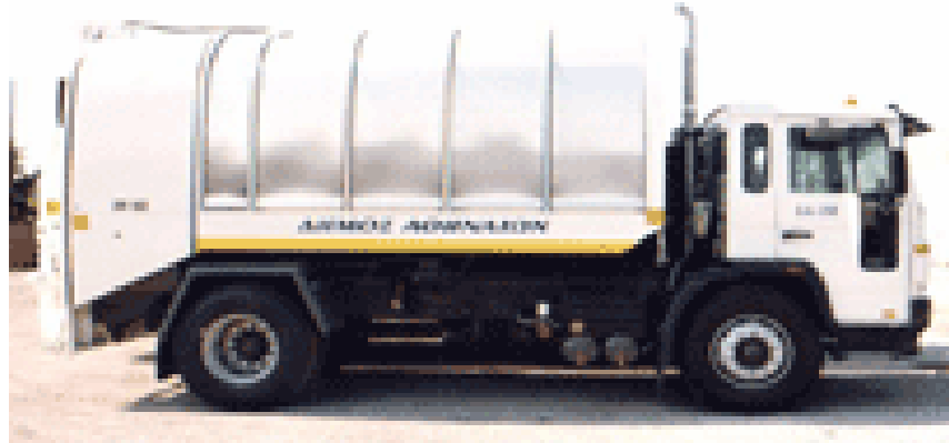
Εικόνα Γ44. Απορριματοφόρο όχημα μεγάλου κυβισμού τύπου περιστρεφόμενου τυμπάνου 18 .
