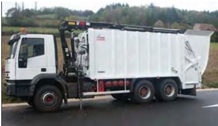
Εικόνα Γ19. Γερανοφόρο όχημα αποκομιδής απορριμμάτων από ημιπύργειους κάδους.
