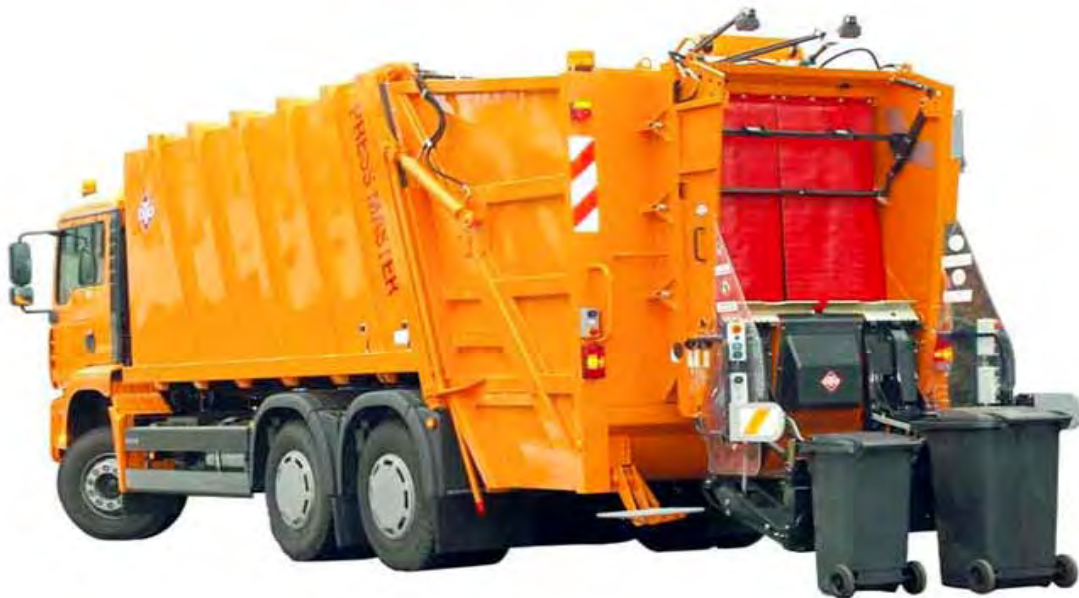
Εικόνα Γ38. Απορριματοφόρο όχημα οπίσθια φόρτωσης κάδων απορριμμάτων με πρέσα.
