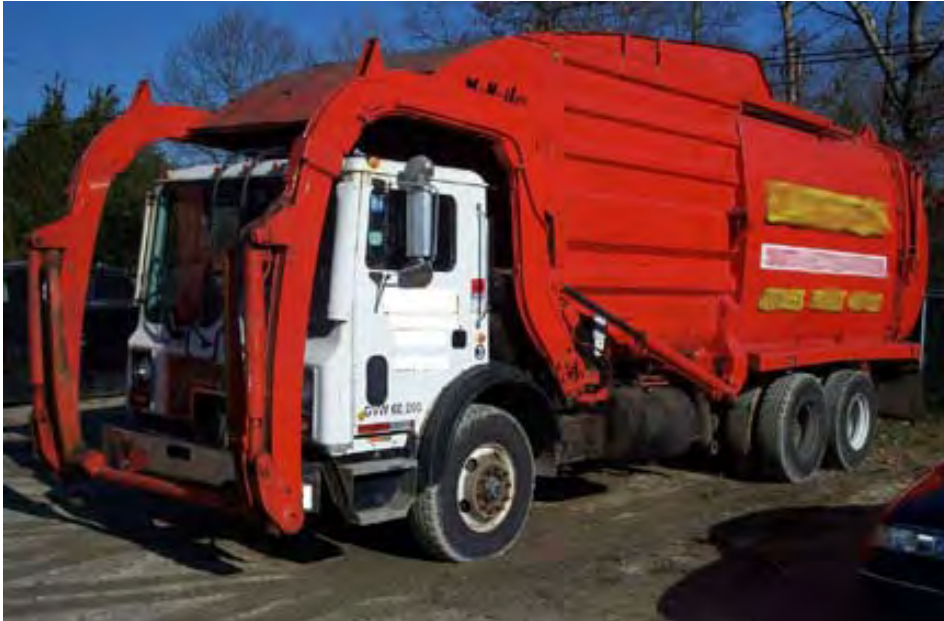
Εικόνα Γ42. Απορριματοφόρο όχημα αυτόματης συλλογής (εμπρόσθιας φόρτωσης.)
