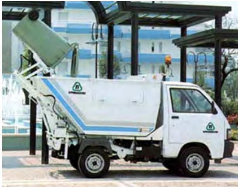
Εικόνα Γ49. Εκκένωση κάδου σε δορυφορικό απορριματοφόρο όχημα 23 .
