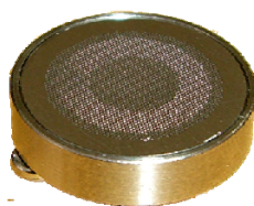
Σχήμα 10. Παθητικός συλλέκτης αιωρούμενων σωματιδίων (διάμετρος 1.5 cm).
