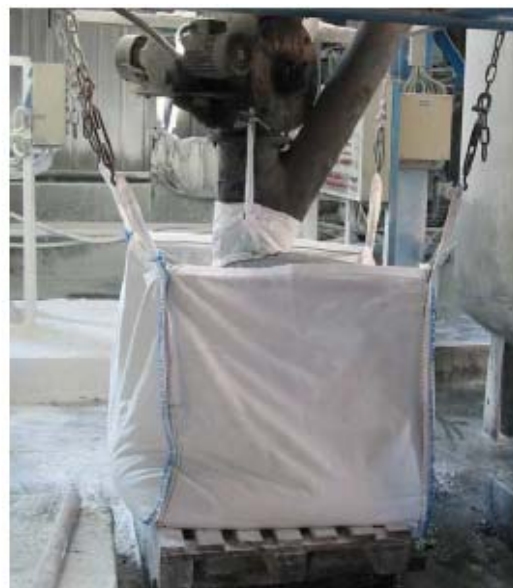
Εικόνα 32: Χοάνη συλλογή ιπτάμενης τέφρας και αποθήκευσή της (ΕΣΔΚΝΑ, 2007).
