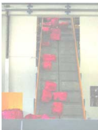
Εικόνα 30: Τροφοδοσία του κλιβάνου με ταινιόδρομους και με αναβατόριο (ΕΣΔΚΝΑ, 2007).
