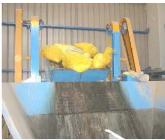
Εικόνα 30: Τροφοδοσία του κλιβάνου με ταινιόδρομους και με αναβατόριο (ΕΣΔΚΝΑ, 2007).
