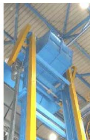
Εικόνα 30: Τροφοδοσία του κλιβάνου με ταινιόδρομους και με αναβατόριο (ΕΣΔΚΝΑ, 2007).
