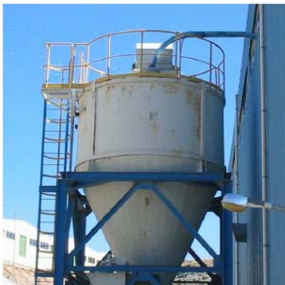
Εικόνα 32: Χοάνη συλλογή ιπτάμενης τέφρας και αποθήκευσή της (ΕΣΔΚΝΑ, 2007).
