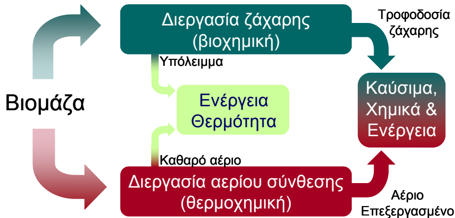
Εικόνα 2-4: Βιοδιυλιστήριο: Μετατροπή βιομάζας σε καύσιμα, χημικά και ενέργεια μέσω βιοχημικής και θερμοχημικής μετατροπής
