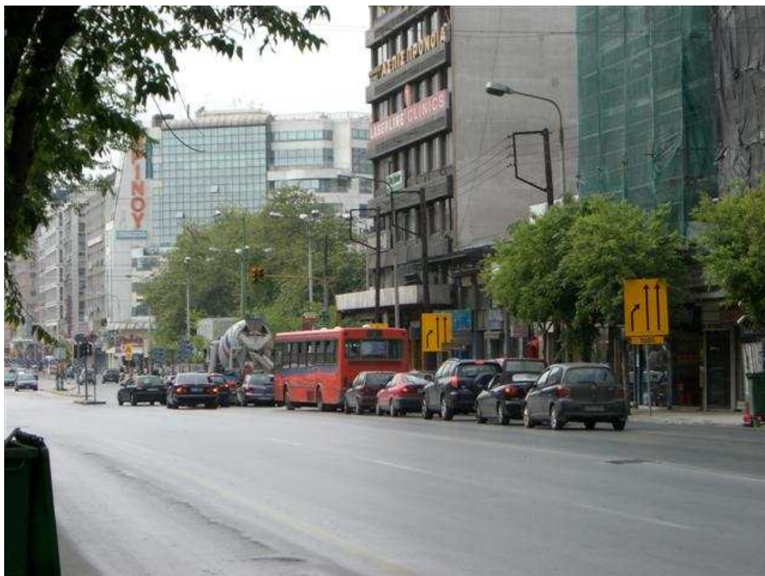
Εικόνα 16: Προειδοποίηση για συγχώνευση λωρίδων κατά την προσέγγιση στο εργοτάξιο Σταθμού Δημοκρατίας
