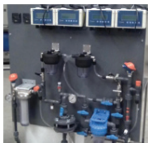
Εικόνα 1: Σχηματικό διάγραμμα καινοτόμου διάταξης/“φίλτρου” ηλεκτροχημικής οξείδωσης οργανικών ρύπων του νερού με βάση καταλυτικά νανοσωματίδια
