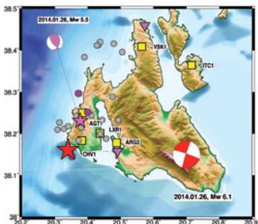
Σχήμα 1. Το επίκεντρο του κύριου σεισμού της 26/1/2014 (M6.1) στην Κεφαλονιά (κόκκινο αστέρι) και κατανομή επικέντρων των μετασεισμών κατά τις πρώτες 2 ημέρες της σεισμικής ακολουθίας (Πηγή: Εργαστήριο Γεωφυσικής ΑΠΘ). Με κίτρινα τετράγωνα συμβολίζονται οι επιταχυνσιογράφοι και με μωβ τρίγωνα οι σεισμογράφοι του ΟΑΣΠ-ΙΤΣΑΚ. Οι μηχανισμοί γένεσης φαίνονται επίσης.
