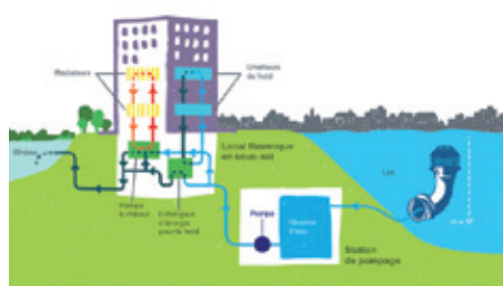
Στο GeniLac Project (2), το νερό της λίμνης της Γενεύης χρησιμοποιείται για θέρμανση ή ψύξη, μέσω ενός αντλιοστασίου και μιας θερμικής εγκατάστασης στο υπόγειο του κτιρίου.
