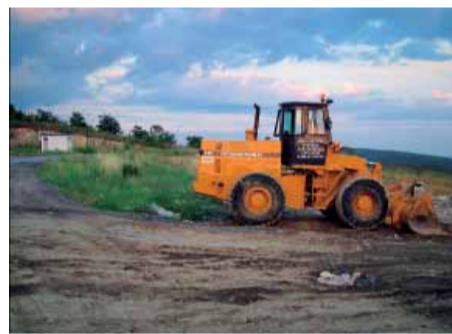
Τα μηχανήματα που χρησιμοποιούνται δε διαθέτουν τις απαιτούμενες προδιαγραφές για τη συγκεκριμένη χρήση (δεν διαθέτουν ερπύστριες)
