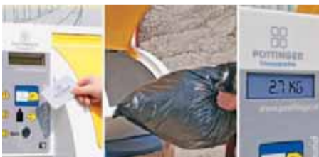
Εικόνα 3. Όψη εξωτερικού κάδου με σύστημα ογκομέτρησης και χρέωσης και λεπτομέρεια κάδου με ζύγιση και χρέωση μέσω 'έξυπνης κάρτας'.
