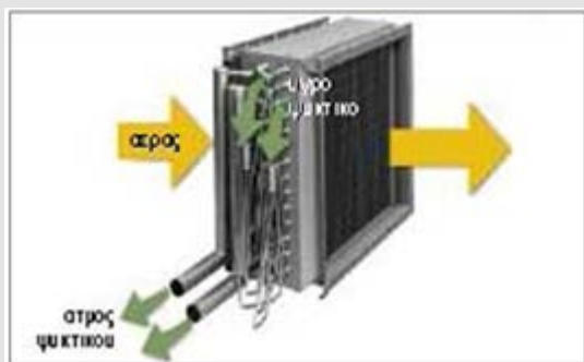
Σχήμα 1.1.22. Εξατμιστής απευθείας εκτόνωσης (ψυκτικό στοιχείο)
