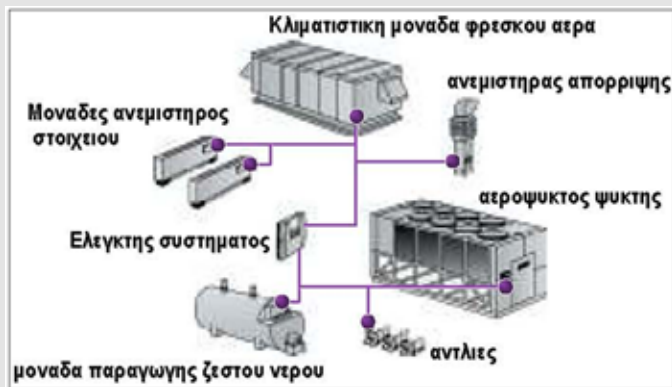
Σχήμα 1.33. Αερόψυκτος ψύκτης, Μονάδες ανεμιστήρα στοιχείου
