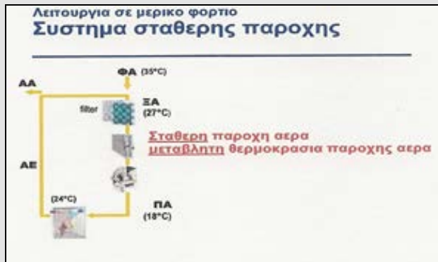
Σχήμα 1.1.6. Λειτουργία σε μερικό φορτίο. Σύστημα σταθερής παροχής
