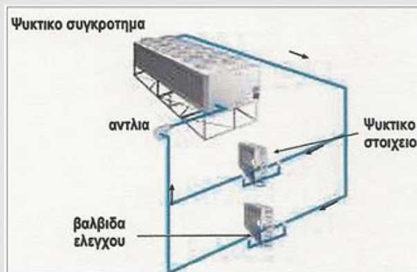
Σχήμα 1.1.15 . Σύστημα κρύου νερού
