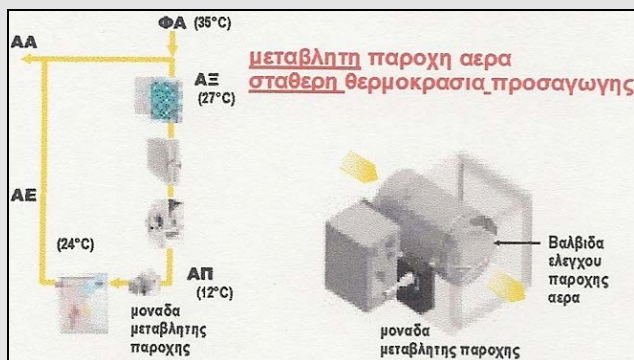
Σχήμα 1.1.7. Λειτουργία σε μερικό φορτίο. Σύστημα μεταβλητής παροχής
