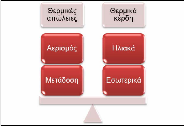
Σχήμα 3.1.2. Ενδεικτικό σχήμα με το οποίο αποδίδεται το ενεργειακό ισοζύγιο των θερμικών απωλειών και των θερμικών κερδών του κτηριακού κελύφους.
